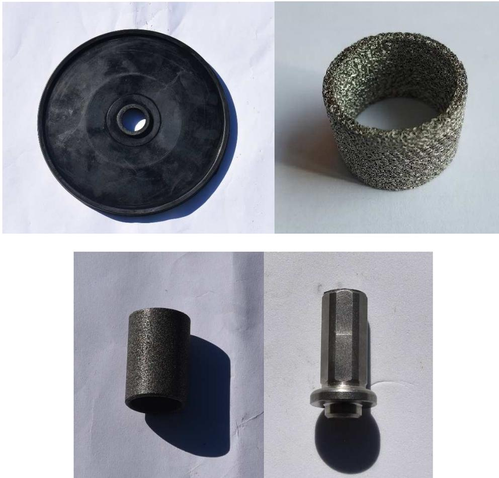
Figura 73. Estado de los componentes del ERM tras estar 3000 horas a 20% de H2 y 80 % de GN en el ERM.
