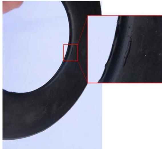
Figura 76. Evidencia de agrietamiento en la junta J6-1H2- Inspección inmediata.
