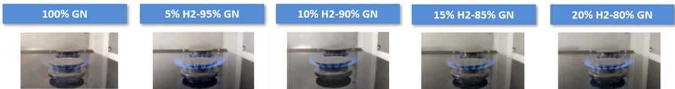
Figura 57. Quemadores en funcionamiento con diferentes mezclas de H2/GN.
