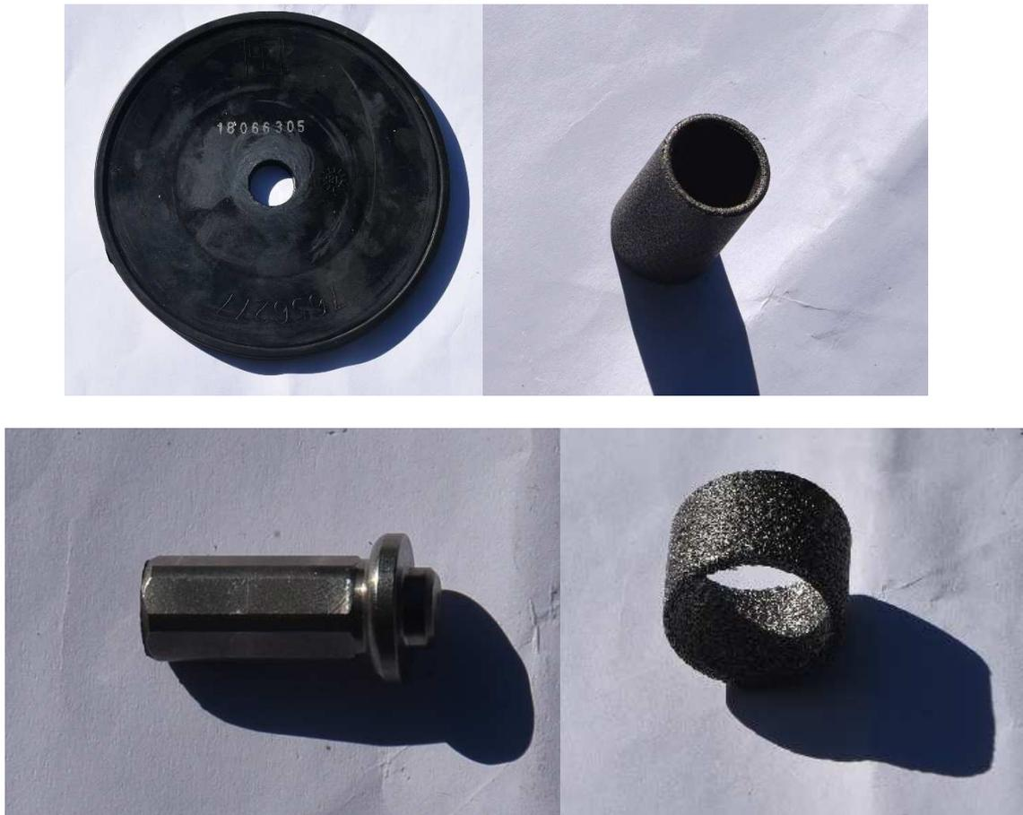
Figura 72. Estado de los componentes del ERM tras estar 2880 horas a 100% de H<sub>2</sub> en autoclave.
