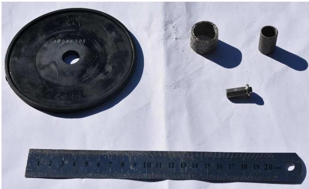
Figura 71. Estado de los componentes del ERM tras estar 2880 horas a 100% de H<sub>2</sub> en autoclave.
