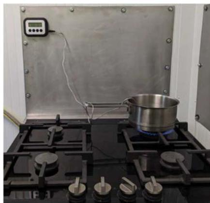
Figura 58. Estudio de la velocidad de calentamiento del agua a diferentes mezclas GN/H<sub>2</sub>.
