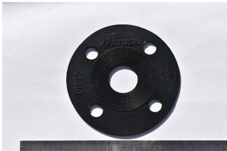
Figura 64. Juntas NBR-2 (Referencia J5).
