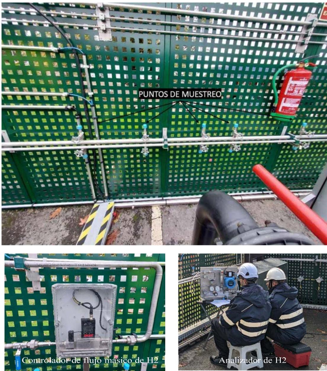
Figura 33. Puntos de muestreo y trabajos en campo con el analizador de H<sub>2</sub>.
