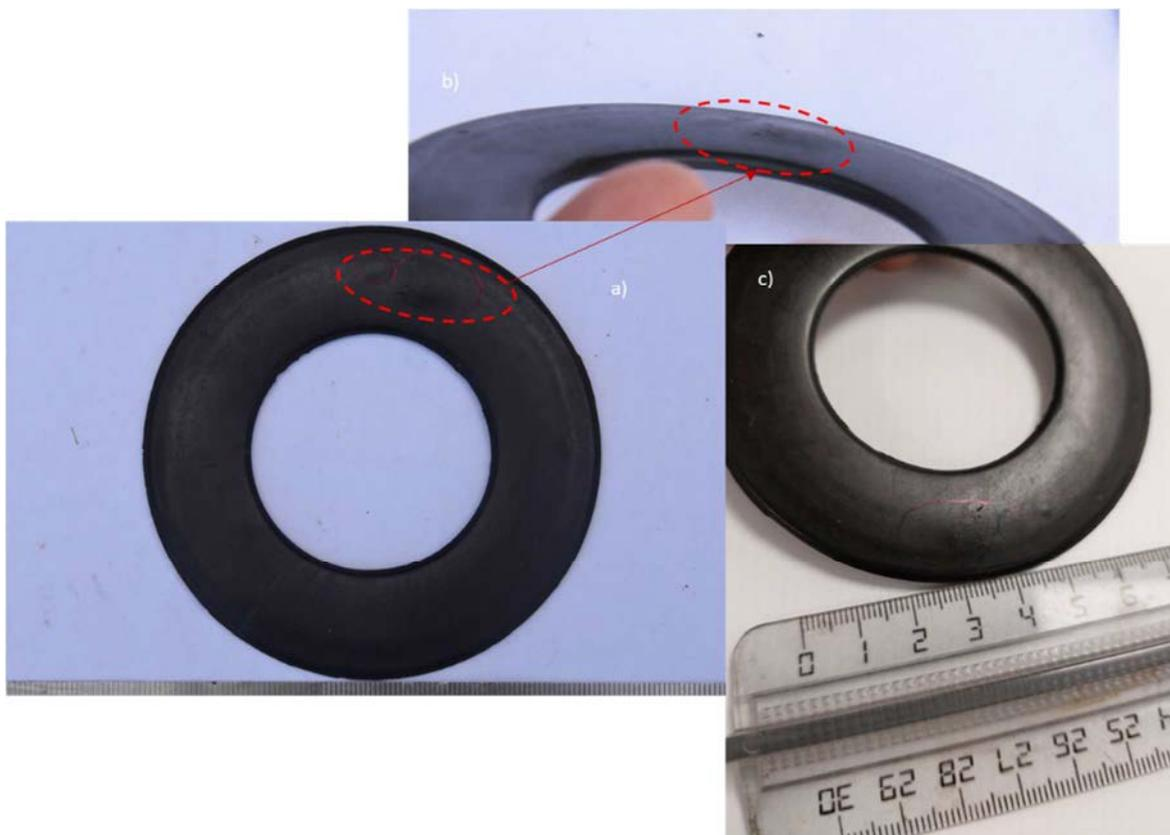
Figura 75. Evidencia de ampollamiento de la junta J1-3H2-COMP-2.a) Inspección inmediata b) Inspección inmediata (perspectiva) c) Inspeccion a las 24h sin signos de ampollamiento.
