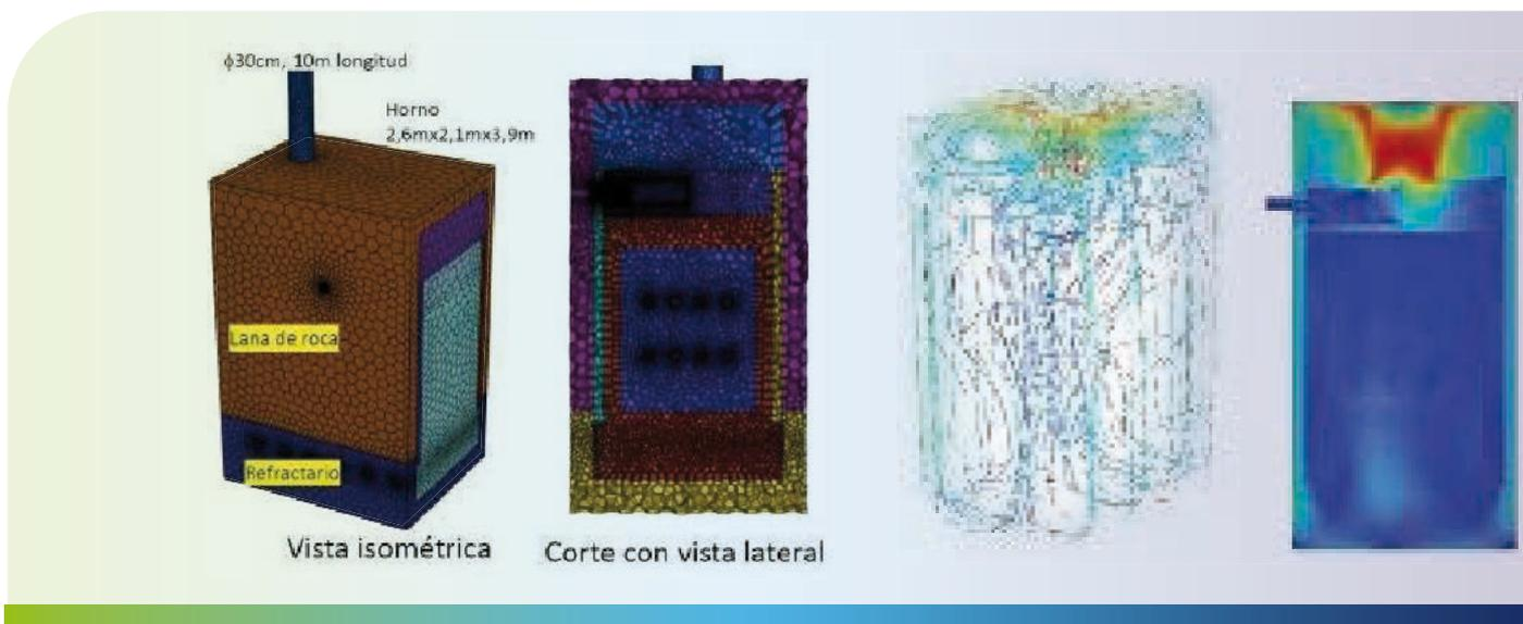
*En la figura de la izquierda se muestra la vista del mallado de horno utilizado en la simulación CFD, con 2,5 millones de celdas y en la figura de la derecha el flujo de los gases de combustión dentro del horno*
