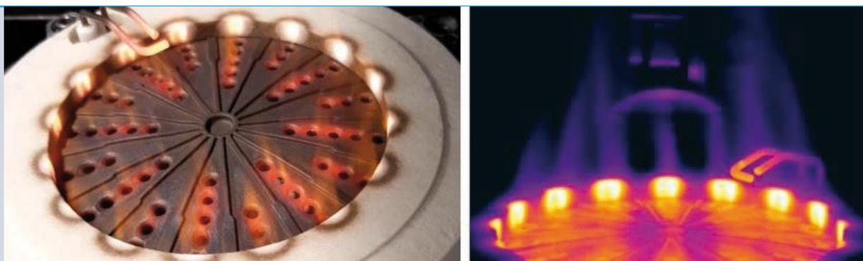
*Figura, Puerta- quemador impresa en fabricación aditiva 3D*
